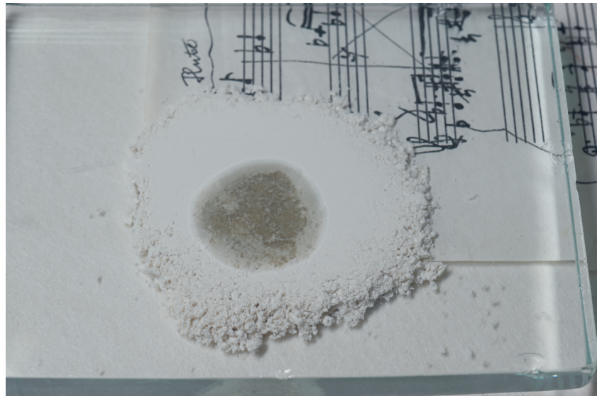
Abbildung 8 Skizze, Kompressse aus Meerschaumstaub mit Benzin
