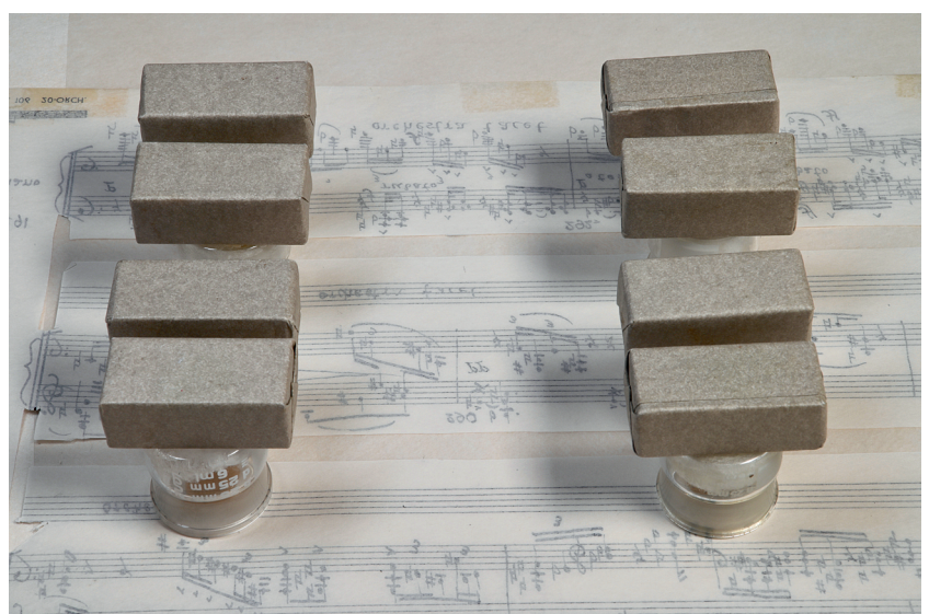
Abbildung 10 Particell, Seite 24, Lösemittelbedampfung der Klebestreifen auf der Blattrückseite
