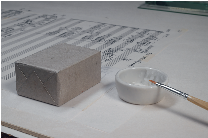
Abbildung 9a Particell, Seite 24, Rissverklebung mit Weizenstärkekleister
